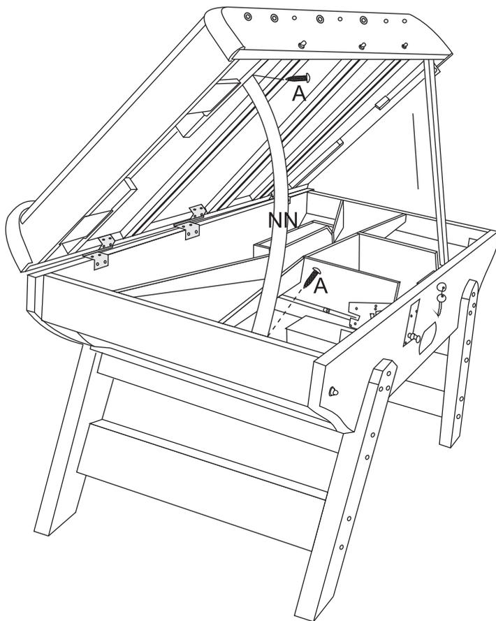
Le côté le plus large du ressort doit être inséré dans le palier de la planche latérale.
