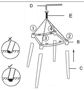
Étape 1 : Assemblez les 4 pieds sur la structure en métal et ajustez les pieds dans la bonne direction comme indiqué ci-dessus au sol jusqu'à ce qu'ils soient équilibrés, puis serrez les 4 vis dans l'ordre de ① à ④ à 100%
