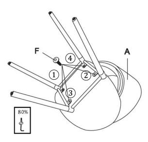
Étape 2 : Assemblez la base sur le siège, et serrez les 4 vis dans l'ordre de (1) à (4) à 80%
